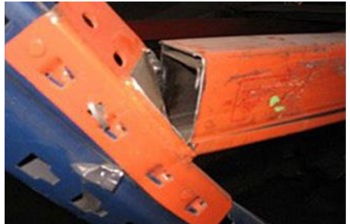
Abb. 2.23.6 und 2.23.7 > Versagen in der Ebene («in plane») infolge ungenügender Verbindung und Verankerung
