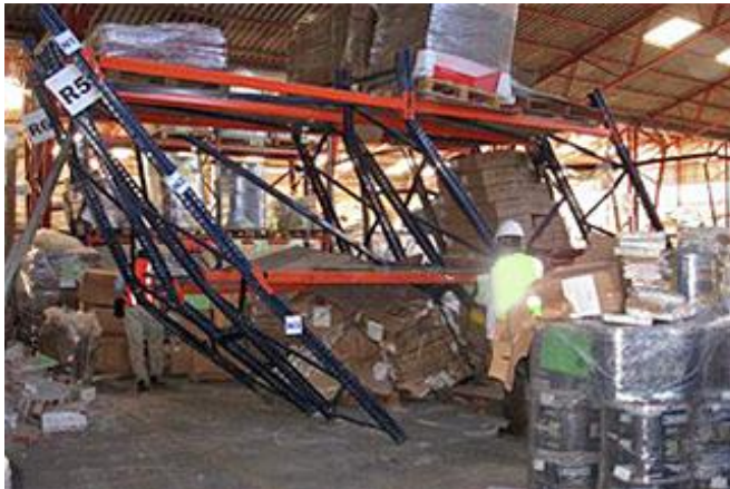
Abb. 2.23.6 und 2.23.7 > Versagen in der Ebene («in plane») infolge ungenügender Verbindung und Verankerung
