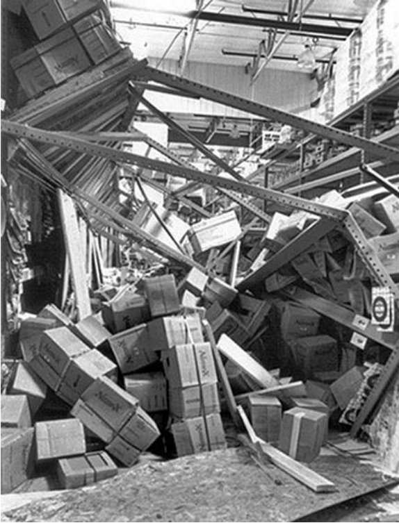
Abb. 2.23.1, 2.23.2 und 2.23.3 > Eingestürzte Hochregallager
