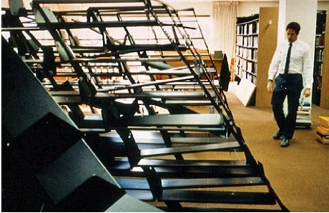
Abb. 2.22.1 und 2.22.2 &gt; Versagensmechanismus in der Ebene («in plane») bei Regalen
