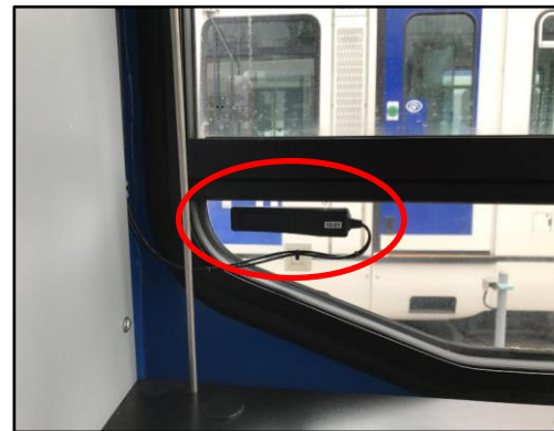
GPS- und Mobiltelefon-Antenne
