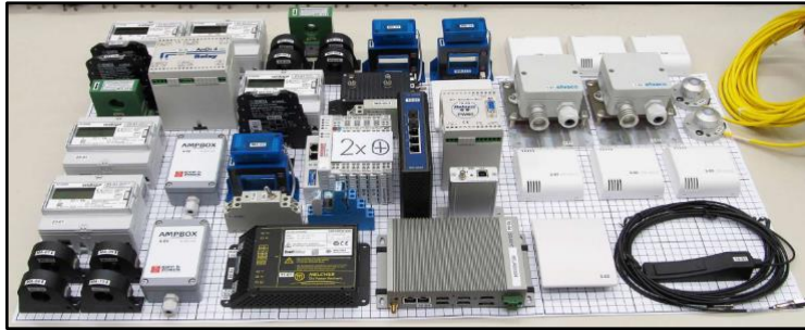
Überblick über die in Komposition 218 eingebauten Sensoren
