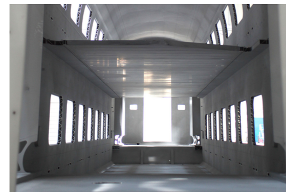
Wagenkasten in Integralbauweise Quelle: Stadler
