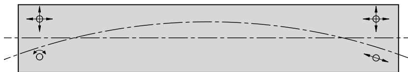
Abbildung 4-3: Lagerungsschema eines Brückentragwerks mit unterschiedlicher Tragwerks- und Gleisachse
