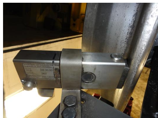
Abbildung 5-5: Einbau Fahrzeugvorrichtung mit Festschmierstoffsystem
