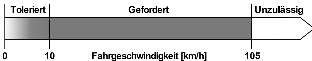
Abbildung 4-1: Geschwindigkeitsschwellen zur Steuerung der Spurkranzschmierung.
