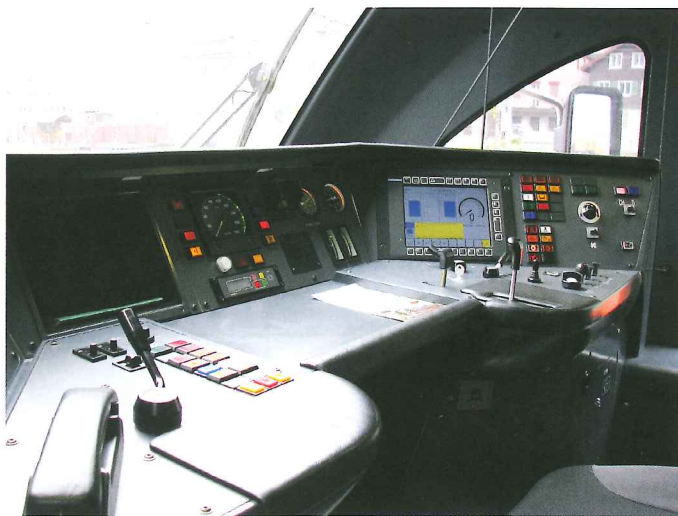
BILD 4: Führerstand mit Fahr- schalter (rechts) am FLIRT 521 019 (Foto: Steffen Schranil)
