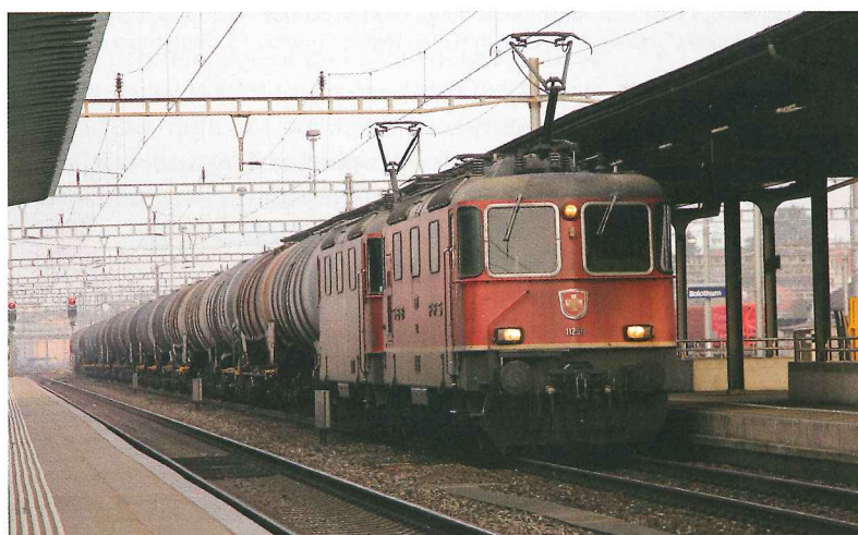
Bild 2: Stoßrichtung 1, Re 10/10 bei Durchfahrt in Solothurn: Schwere Güterzüge zur Überholung „auf die Seite zu stellen“, kostet wertvolle Streckenkapazität und Energie (Foto: Steffen Schranil, 15. Dezember 2015).
