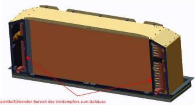
Dichtebene kältemittelführender Bereich des Verdampfers zum Gehäuse
