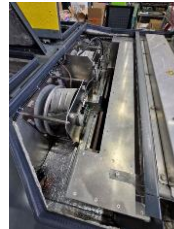
Dichtebene kältemittelführender Bereich des Verdampfers zum Gehäuse
