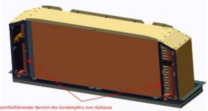
Dichtebene kältemittelführender Bereich des Verdampfers zum Gehäuse
