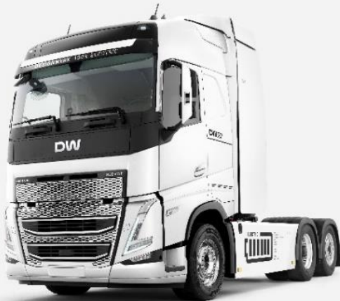
Designwerk HC Semi 1'000 kWh 6x2T mit ca. 600 km Reichweite (TW 42 t)
