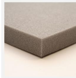
Plastazote MP15 FR ist ein geschlossenzelliger Polyäthylenschaumstoff, welcher in verschiedenen Qualitäten und Dichten erhältlich ist. MP15 FR weist eine mittlere Dichte von 15 kg /m<sup>3</sup> auf und ist zusätzlich flammenhemmend behandelt. MP15 FR ist bei einigen Eisenbahnfahrzeugen im Betrieb, v.a. in Seitenwand und Decke.
