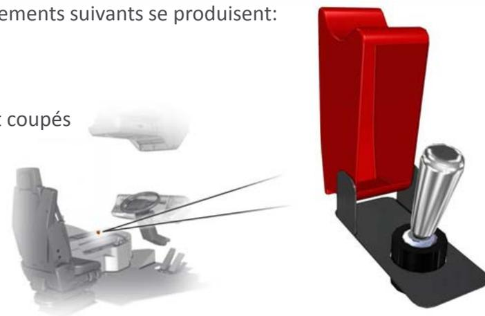
**Important:** N'utilisez le coupe-circuit d'urgence qu'en cas d'urgence. L'utilisation du commutateur d'urgence provoquera des codes d'erreur dans plusieurs systèmes du bus et réduira également la durée de vie de l'unité de déconnexion de batterie (BDU) qui fait partie intégrante de la batterie de traction (600 V CC).
