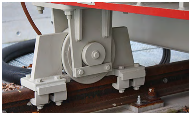
Fig. 2.14.4 &gt; Fixation au moyen de deux sabots d'arrêt par roue
