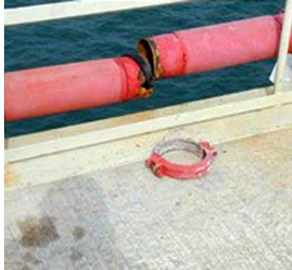
Fig. 2.18.2 &gt; Chute d'une conduite
