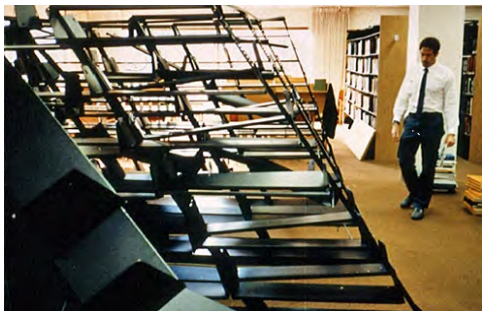
Fig. 2.22.1 et 2.22.2 &gt; Mécanisme de ruine dans le plan («in plane») pour des étagères
