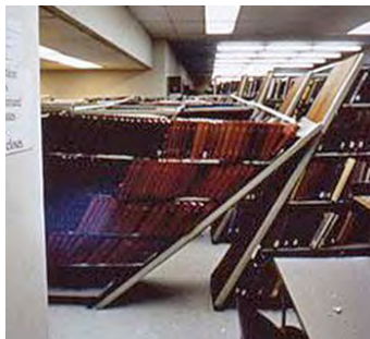
Fig. 2.22.1 et 2.22.2 &gt; Mécanisme de ruine dans le plan («in plane») pour des étagères
